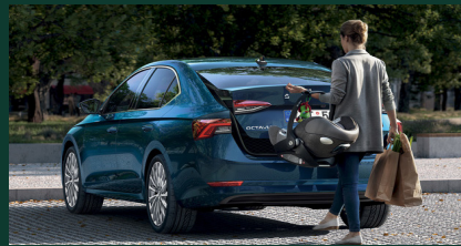
Bezdotykowo otwierana elektrycznie sterowana pokrywa bagażnika
